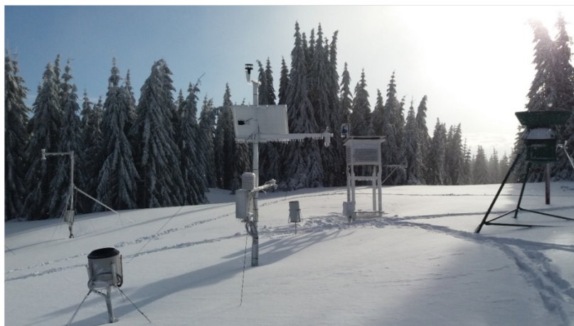
Obrázok 5. Porovnanie ručne meranej VHS so snehomernou váhou na Červenci v zimnej sezóne 2016 a 2017.
