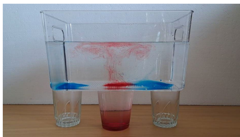
Obrázok 5 Stúpanie vody nahor v dôsledku ohrievania odspodu
