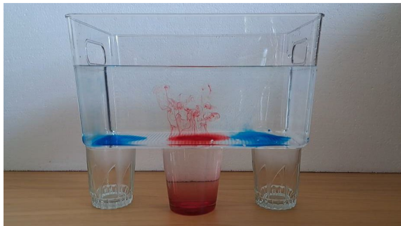
Obrázok 4 Ohrievanie vody v nádobe pomocou pohára s horúcou vodou
